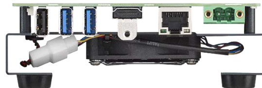
Front Side: I/O and Fan
